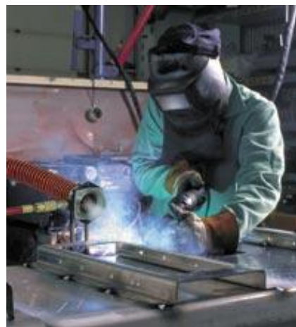
利用放大器吸除焊接烟气
